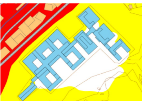
Sumstøy (uten skjerpet krav for impulsstøy fra havn, 0-alternativet for havna med nye bygg mot nord som gir skjerming)
