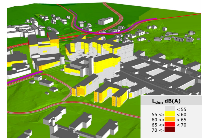
Fasadestøy, sett fra nord. Illustrasjon: Rambøll
