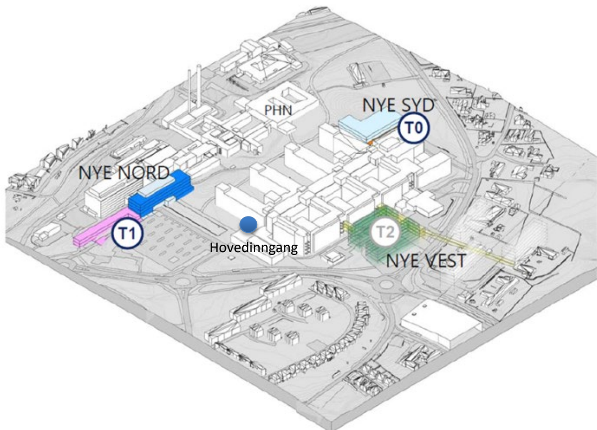
Figur 3: Byggetrinn 1 (T1, strålesenter og universitetsarealer) anbefales plassert ved Nye Nord, byggetrinn 2 (T2, framtidig kapasitetsutvidelse, sengebygg m.m.) plasseres på konsulattomten Nye Vest, og byggetrinn 0 (T0, sengerom og bildediagnostikk) plasseres sør for dagens sykehus Nye Syd. Geometri og fotavtrykk for de nye byggetrinnene er kun illustrativt tegnet inn, og vil bli optimalisert i senere faser. Prosjektet nybygg psykisk helsevern (PHN) er under gjennomføring og vil ta i mot nye pasienter fra 2026.
