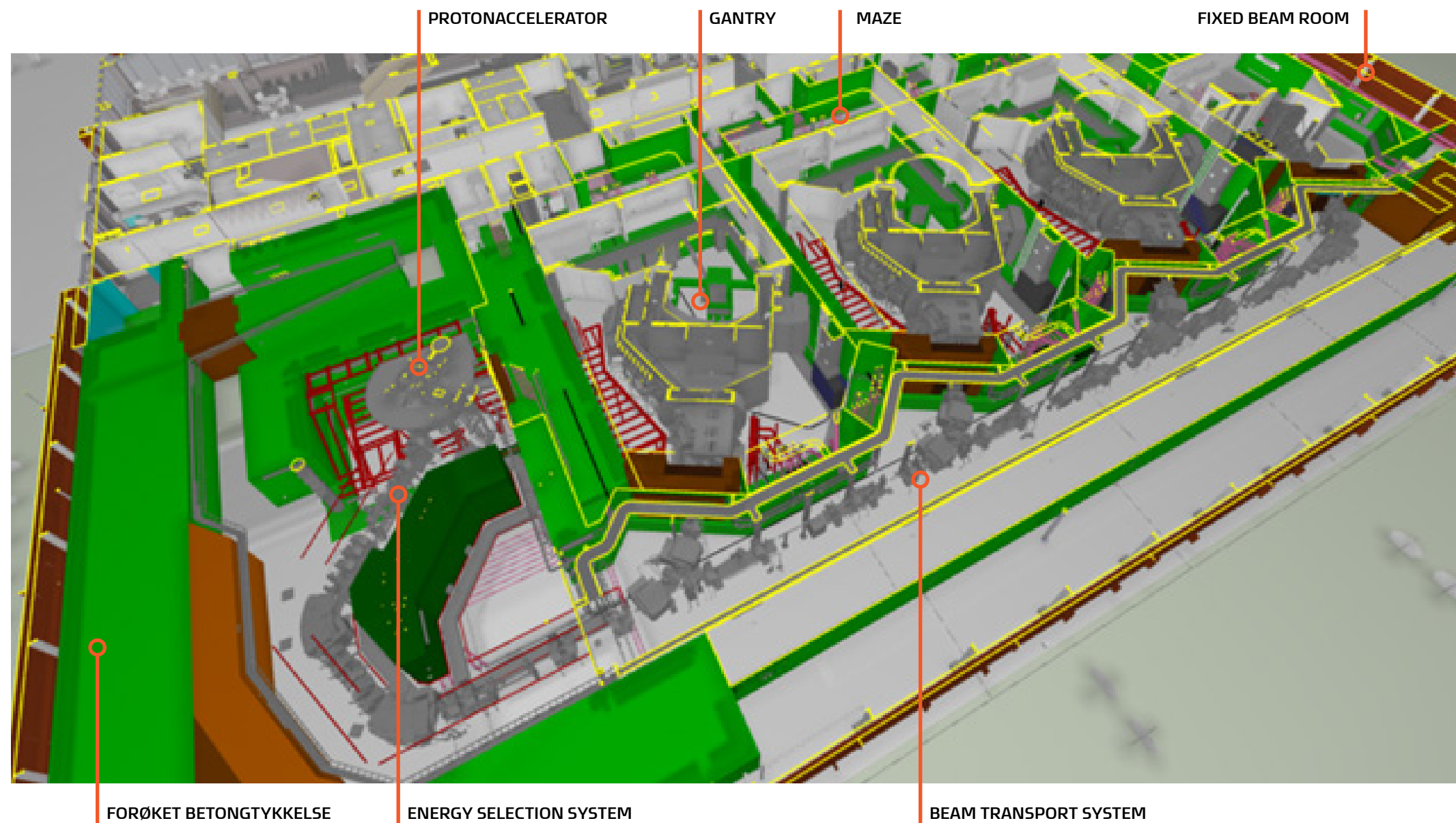
Aksonometrisk plansnitt som viser oppbygning
